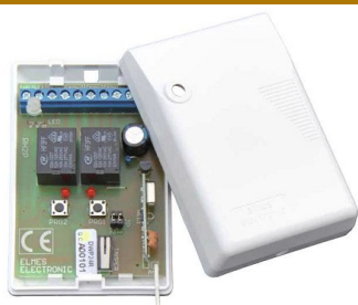
DWP12R / DWP24R 2-канальные супергетеродинные приемники с силовыми реле
